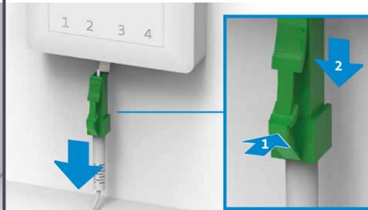
Merken Sie sich die Steckplatz Nummer. Drücken Sie den Hebel an den Stecker (1), dann lässt sich das Kabel leicht herausziehen (2).
