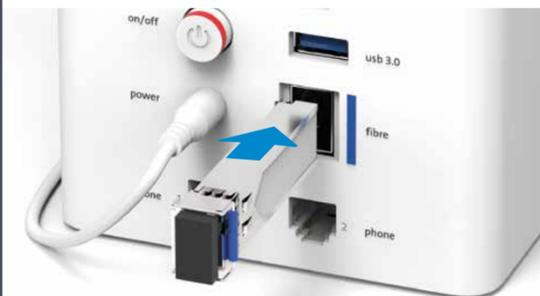
Schieben Sie das Glasfaser-Modul in den «fibre» Einschub ein, bis es einrastet. Die blauen Markierungen auf Glasfaser-Modul (Bügel) und Internet-Box gehören auf die gleiche Seite.
