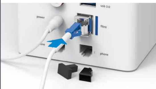
Nehmen Sie die Schutzkappen ab und schliessen Sie das blaue Ende des Glasfaserkabels an der Internet-Box an.
