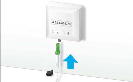
Öffnen Sie bei der Glasfasersteckdose den Steckplatz, den wir Ihnen per Brief angegeben haben. In der Regel ist dies Steckplatz 2, selten 1. Nehmen Sie die Schutzkappe ab, und schliessen Sie das **grüne** Ende des Kabels an.
