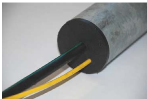
Abbildung 16: Hauseinführung 2“ gerade, Stahlrohr gerade 60.3x2.9 / Länge 700mm: Art. 130.241.3 (HG-Commerciale)
